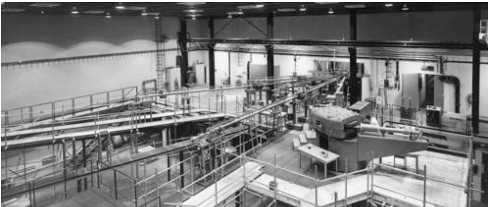
Der van de Graaff-Beschleuniger war seit den 60er Jahren das zentrale Gerät der Kernphysik. Die Abbildung zeigt die Messplätze am van de Graaff-Beschleuniger.
