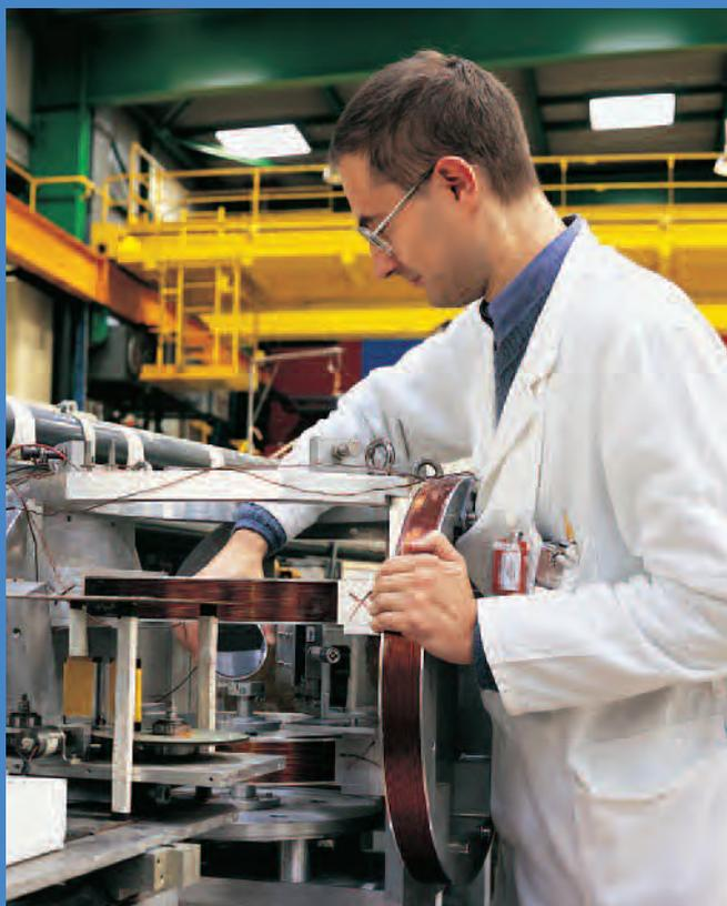
Mise en place d'un échantillon sur un spectromètre à champ magnétique variable pour étudier son aimantation interne.
