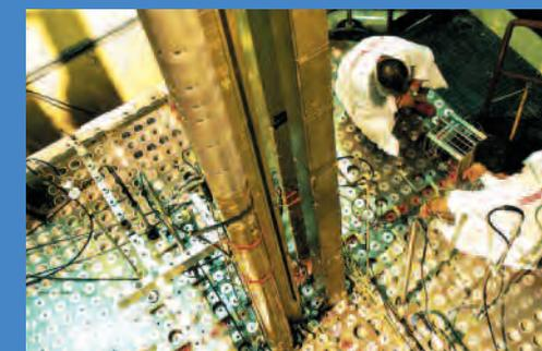
Vue de dessus de la plaque mécanosoudée qui supporte tous les assemblages combustibles du réacteur Masurca.
