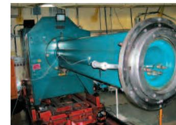
Machine d'extraction des doigts de gant.
