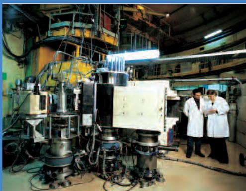
Deux doctorants se concertent avant de démarrer une expérience sur un spectromètre 3-axes.
