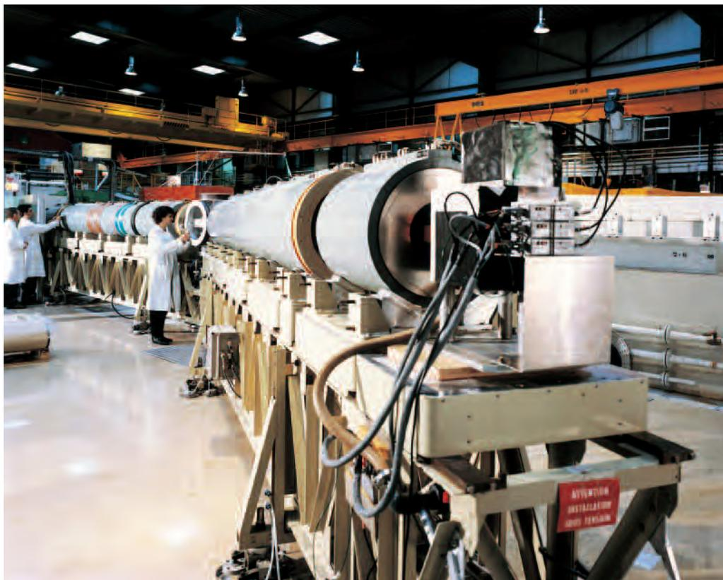
Le spectromètre à écho de spin « Mess ».
