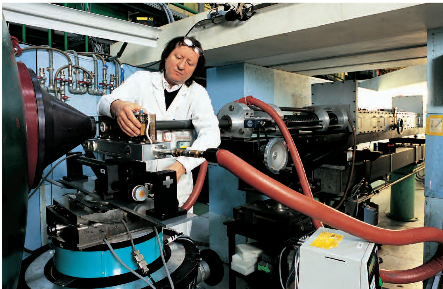
1. Mise en place d'échantillons et derniers réglages avant l'ouverture du faisceau de neutrons.
