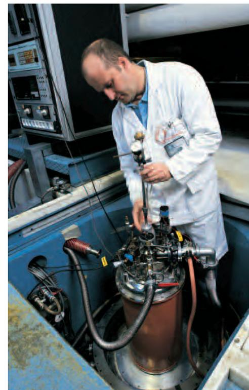
Mise en place d'un échantillon dans un cryostat sur Mibémol (G 6.2).
