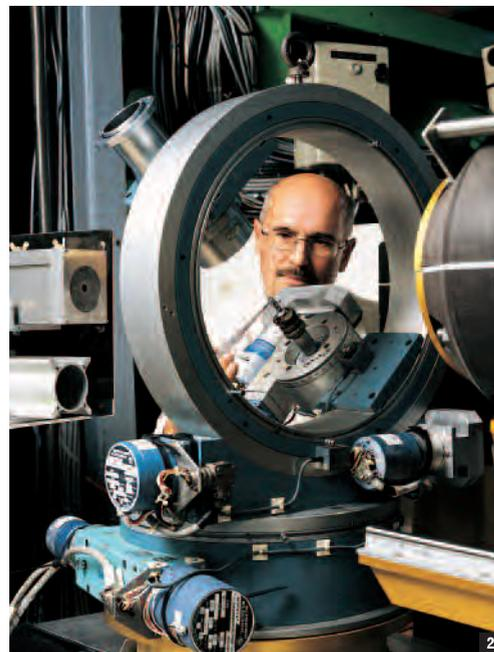
suivant une direction précise (vers le haut ou vers le bas). Pour ce faire, on utilise soit des monochromateurs polarisants, soit des Super Miroirs qui, placés sous champ magnétique, réfléchissent uniquement les neutrons dont le spin est dirigé vers le haut ; un « flipper », créant un fort gradient de champ, permet d'obtenir ensuite une polarisation vers le bas.
